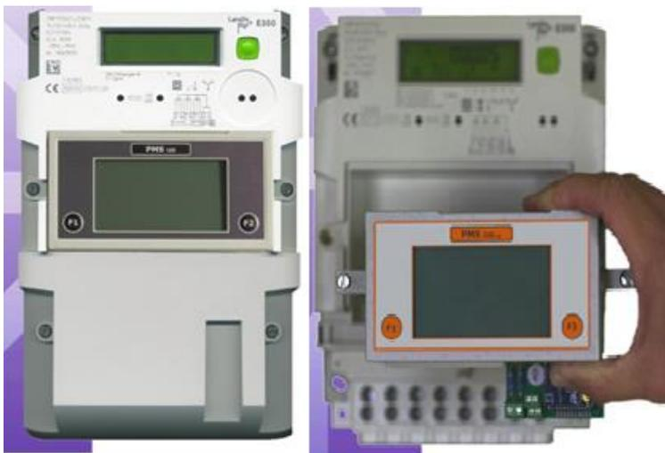
Abbildung 40: Elektronischer Zähler mit Aufsatzmodul zur Nutzung als PPZ (Quelle: PMS)
