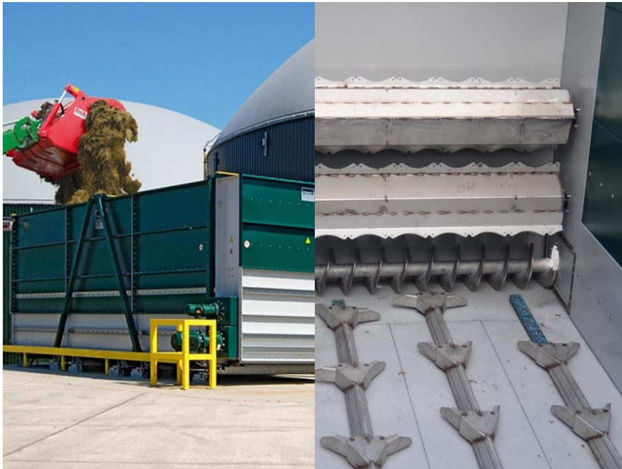
Abbildung 14: Vorlagebehälter und Schubboden mit Auflösewalze und Pressschnecke [30]
