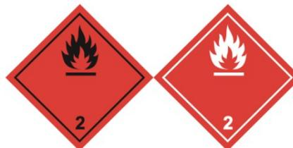
Abbildung 14: Gefahrzettel Nr. 2.1 – Quelle: Abschnitt 5.2.2.2.2 ADN
